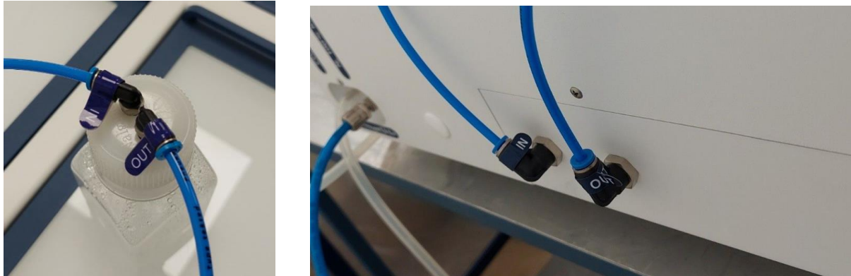
Slika 23.1 Spajanje cijevi na boci za humidifikaciju i višeprostornom IVF inkubatoru MIRI® Humidity
