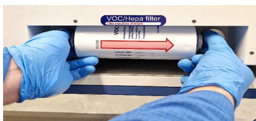
Slika 12.2 Postupak umetanja i uklanjanja VOC/HEPA filtra
