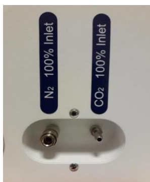
Slika 11.1 Ulazi za plin na stražnjoj strani višeprostornog IVF inkubatora MIRI® i MIRI® Humidity.
