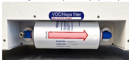
Slika 12.3 Pravilno ugrađen VOC/HEPA filter
